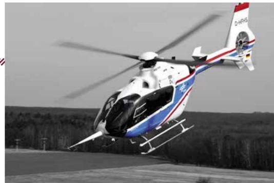
den Rotorseite in der Nähe der Drehachse sogar Rückströmungen am Rotorblatt auf. Durch diese über den Rotorlauf stark variierende Anströmung der Rotorblätter ist zum Erreichen eines getrimmten Flugzustandes eine zyklische, sinusförmige Verstellung des Rotorblattanstellwinkels notwendig.
